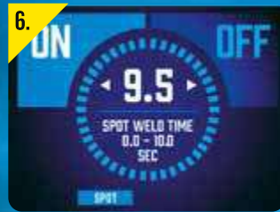
6. スポット 溶接画面 半自動溶接モードのみ
