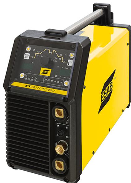
ET 301i AC/DC は、2000Hz の超高連パルス制御機能搭載、高出力、フルデジタル制御、AC/DC、手溶接 / リフト TIG/HF TIG のインバータ電源で、入力電圧の範囲が広いこと、最大限の柔軟性を実現します。このユニットは、すべての溶接可能な材料の精密 TIG 溶接と手溶接に特別に設計されています。優れた真の AC 正方波出力がバランスとクリーニング機能と組み合わせられ、アルミニウムとマグネシウム合金の溶接時のタングステン寿命を延ばすための連続的な高周波を必要とせずに、比類ない溶接性能を提供します。
