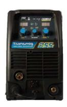
CIGWELD トランスミグ255iは、単相200Vで使用が出来ます。マルチプロセスインバータ電源です。半自動GMAW/FCAW(MIG)、MMAW(手溶接)とアルゴン溶接GTAW(リフトTIG)溶接が行えます。ユニットは、統合されたワイヤ送給装置を備えています。電撃防止装置内蔵であらゆる場所で使用できます。(VRD機能は手溶接モードのみ作動)、そして PFC (力率補正)、デジタル制御により電圧電流のきめ細やかな調整が可能です。スポット、スティッチ、ホールド機能搭載 で現代のプロフェッショナル溶接のニーズに広範囲にお応えします。
